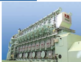
8MW級ガスエンジン
